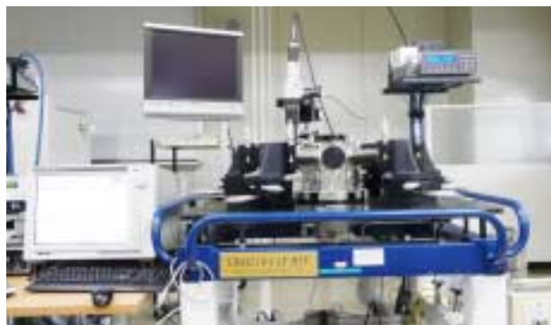
図2 高耐圧真空プローバ「GRAIL」と計測器「B1505A」
